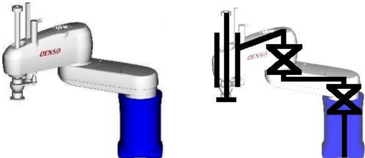
Слика 1.3. Роботска рака со 3 степени слобода на движење со транслациски зглоб ( https://www.societyofrobots.com )
