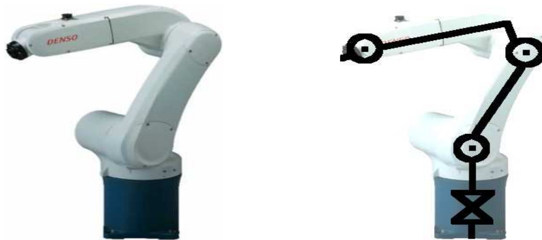
Слика 1.4. Роботска рака со 4 степени слобода на движење ( https://www.societyofrobots.com )
