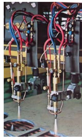
Сл. III.21. Автоматизирано сечење со гасен пламен
