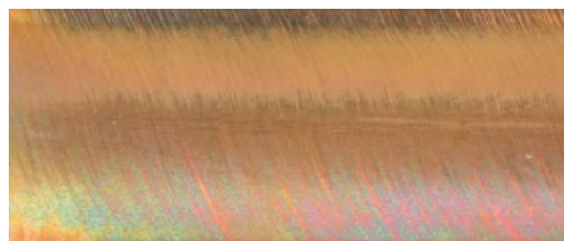
Сечење со секундарен притисок од вртложен гас N 2 и плазмаобразен гас Ar/H 2
