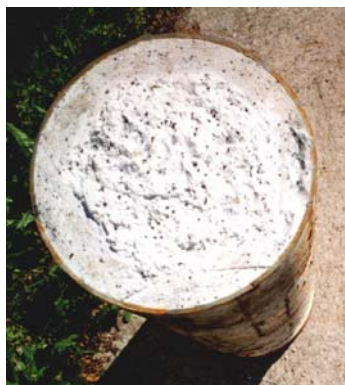
Сл. III.1. Пресек на метално шише за ацетилен
