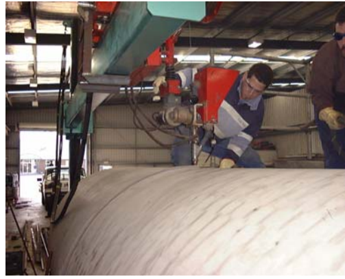
Сл. VI.38. ЕПП заварување со конзолен уред на кружен завар од внатре и надвор
