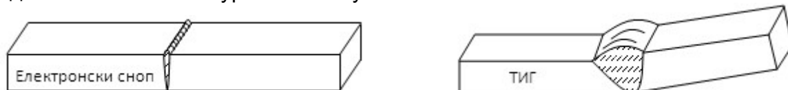
Сл. VIII.12. Споредба на сочелни заварени споеви изведени со електронски сноп и ТИГ електричен лак
