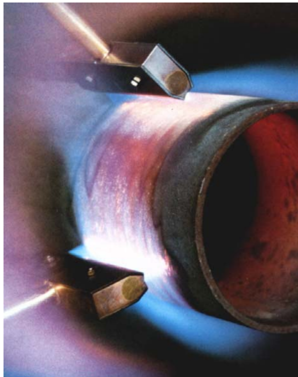
Сл. III.13. Предгревање со гасен пламен
