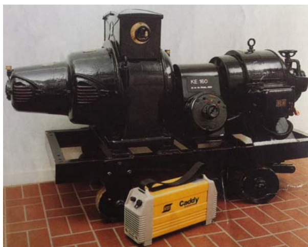
Сл. II.3. „KE 160“ заварувачки конвертор од 1925 година и „ESAB Caddy“ заварувачки инвертор од 1994 година
