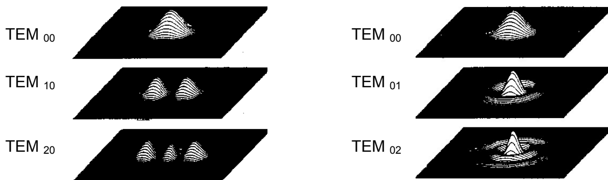
Сл. VIII.21. Распределби на енергијата по попречниот пресек на ласерскиот сноп
