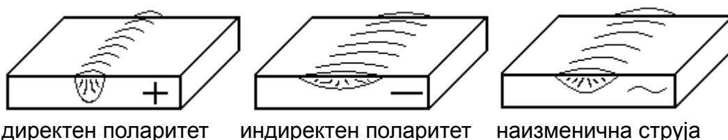
Сл. VI.20. Влијание на видот на струјата и поларитетот на обликот на заварот
