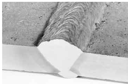
608 Отстапување од централната линија на двостран завар
