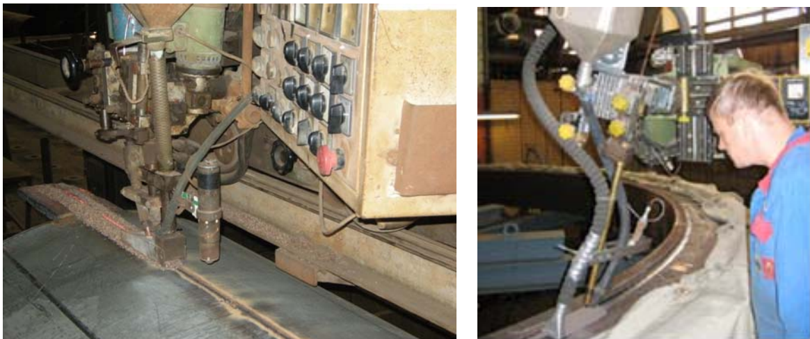
Сл. VI.49. Примена на ЕПП зварувањето
