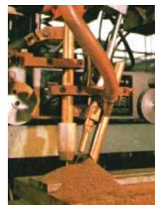
Сл. VI.53. Еднолачно ЕПП заварување со една дополнителна загреана жица
