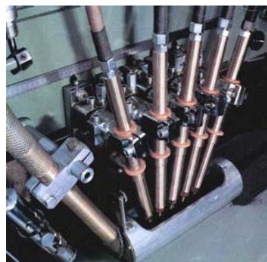
Сл. VI.54. Повеќе лачно ЕПП заварување со повеќе дополнителни загреани жици
