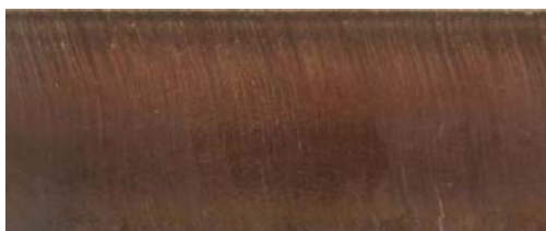
Конвенционално сечење без секундарен медиум, со плазмаобразен гас Ar/H 2 /N 2
