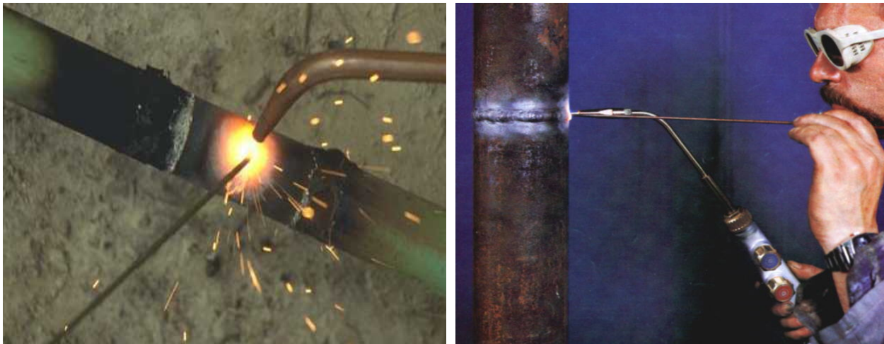
Сл. III.11. Заварување на цевки со оксиацетиленски пламен
