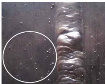
602 Распрскување на додатен материјал
