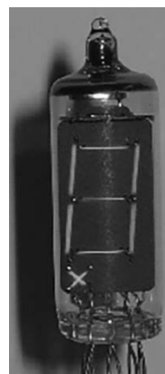
Слика 9.2. Цифра добиена од вжештување на жички, во вакуумска лампа.
