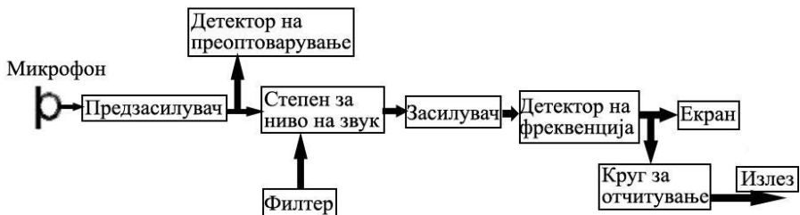
Слика 2.19. Блок шема на сонометар.
