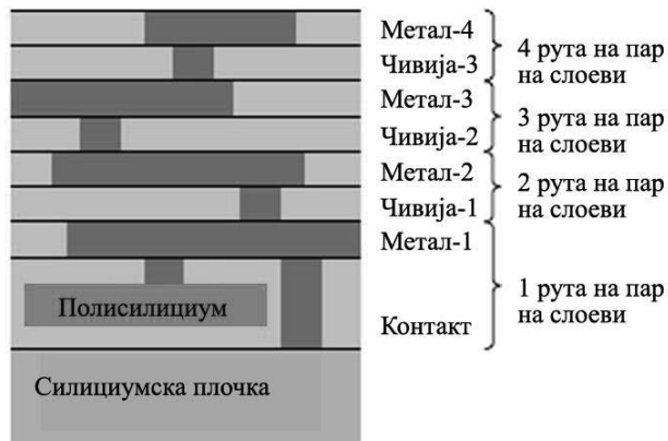
Слика 4.10. Шематски приказ на рутите на метализација.
