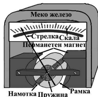
Слика 8.3. Конструкција на аналоген инструмент со подвижна намотка.
