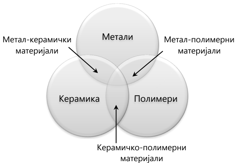
Слика 1-5 Шема на формирање композитни материјали
