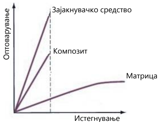
Слика12-3 Зависност истегнување–оптоварување на композитот, матрицата и зајакнувачкото средство [2]
