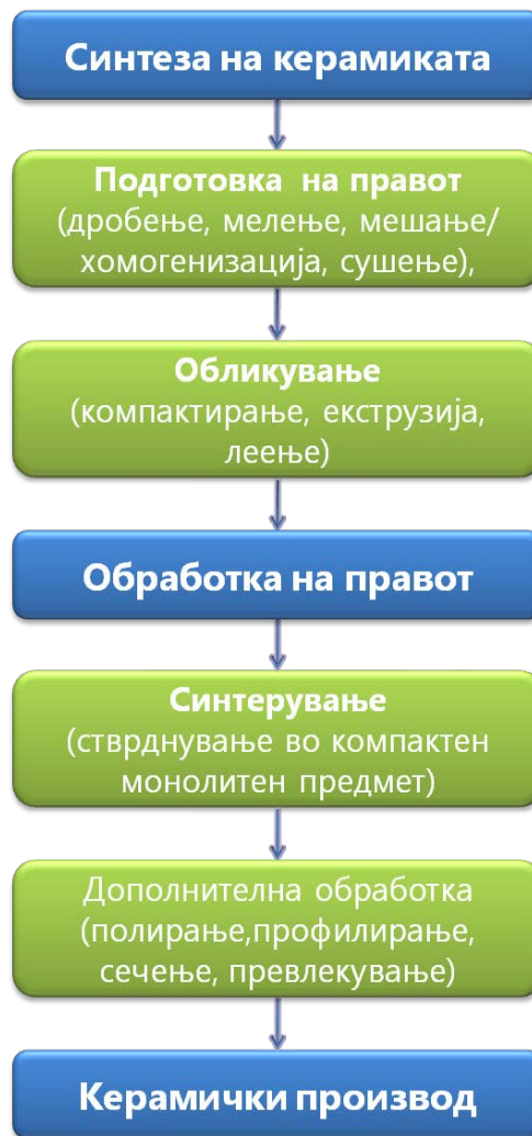
Слика 10-8 Принципиелна шема на процесот на синтеза и обработка на керамичките материјали
