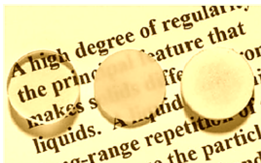
Слика 1-3 Дискови од алуминиумов оксид со различна структура и транспарентност [1]
