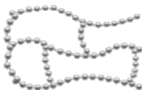
Слика 11-13 Мрежна структура на еластомерите
