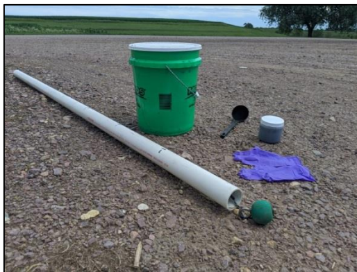
Слика 5. Опрема за земање на примероци кај органски ѓубрива
