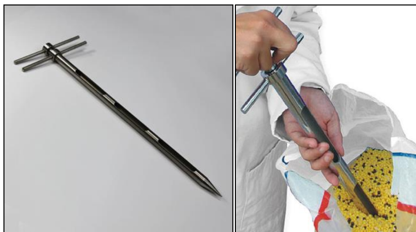
Слика 5. Сонда за земање примероци од минерални ѓубрива
