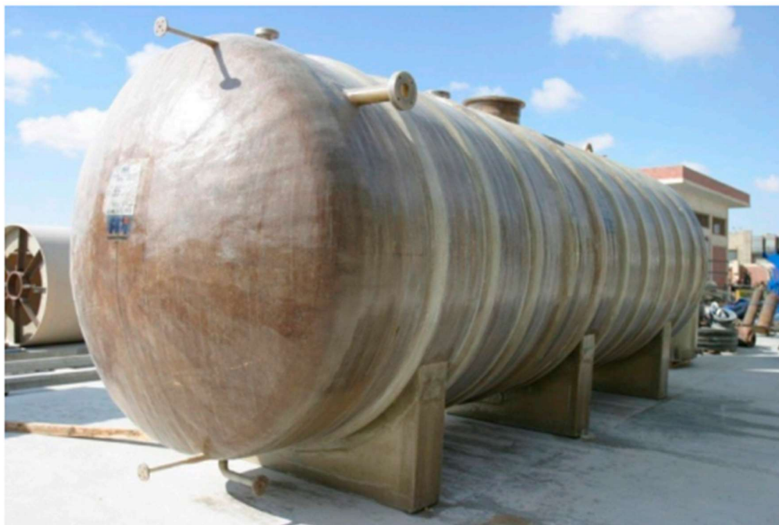
Слика бр.5.3 Сад под притисок изработен од термосет пластика зајакната со стаклени влакна
