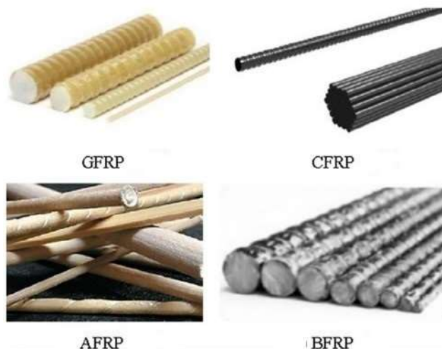
Слика бр.5.6 Композити зајакнати со арамидни влакна (AFRP), со јаглеродни влакна (CFRP), со стаклени влакна (GFRP) и базалтни влакна (BFRP)
