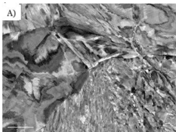
Слика бр.2.3 Дислокациско движење кај високодеформабилен челик
