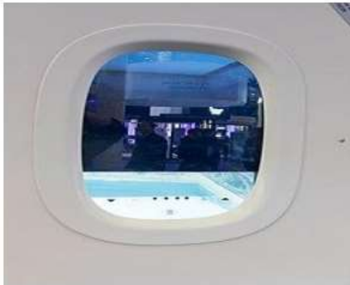
Слика бр.8.6 Примена на електрохромни материјали кај прозорци од авион
