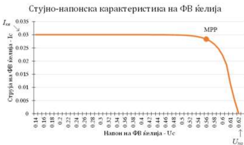
Слика 1.10: Струјно-напонска ( I-U ) карактеристика на типична ФВ ќелија при стандардни испитни услови
