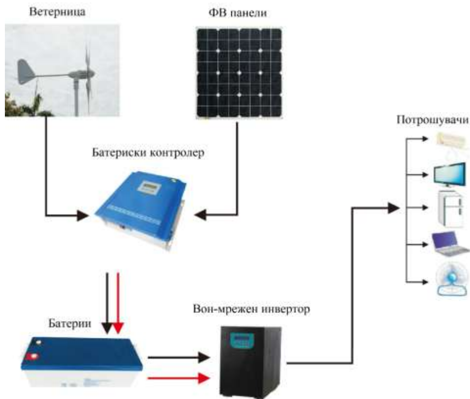
Слика 1.1 Шематски приказ на системот за напојување со ЕЕ и потрошувачите
