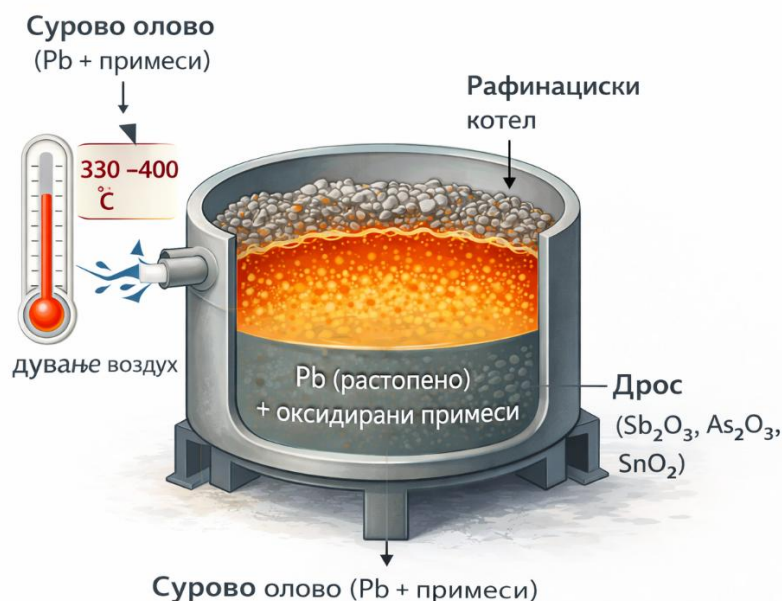
Слика 7.11. Пирометалуршко рафинирање на олово
