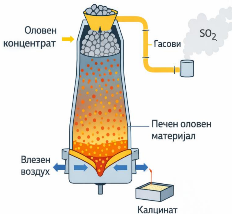
Слика 7.9. Висока печка за производство на олово
