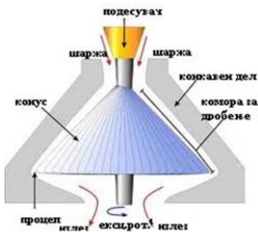
Слика 1.5. Секундарна конусна дробилка
