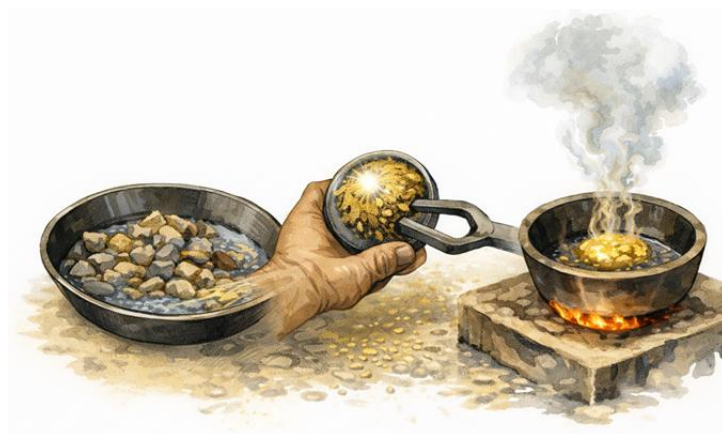
Слика 5.2. Процес на амалгамација на злато со жива
