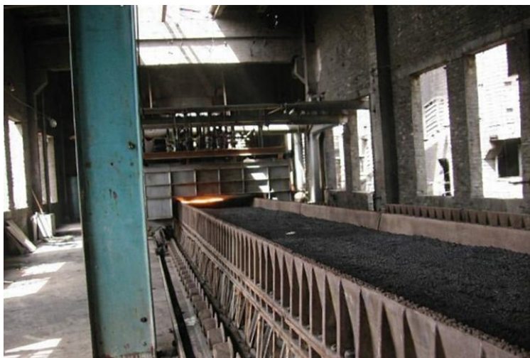
Слика 1.17. Конвеерна машина за сушење и печење пелети
