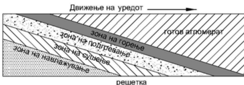
Слика 1.22. Шематски е прикажан долен пресек на агрегатна машина со континуирано дејство од лентен тип
